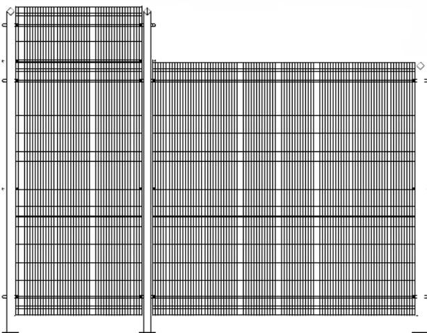
Comp-Line kann Bodenschrägen ausgleichen mit optionalen Gewindestangen, die die Pfosten vom Boden abheben, was auch die Reinigungsfreundlichkeit erhöht.
