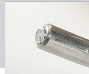
7) CNC-gefast, mechanisch, aussen glatt, innerer Grat.
